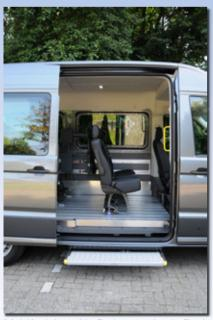
Multifunktions Alu-Boden, maximale Flexibilität, ausfahrbare Trittstufe, zusätzliche Haltegriffe, Einzelsitze mit Armlehne.
