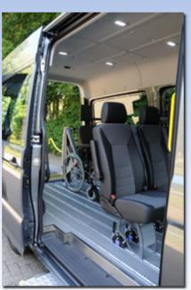
Der Aluminium-Boden mit eingelassenen Alu-Rasterschienen zur Aufnahme der Einzelsitze, der Retraktoren für den Rollstuhlplatz, für eine Fahrtrage oder einen Tragestuhl.
